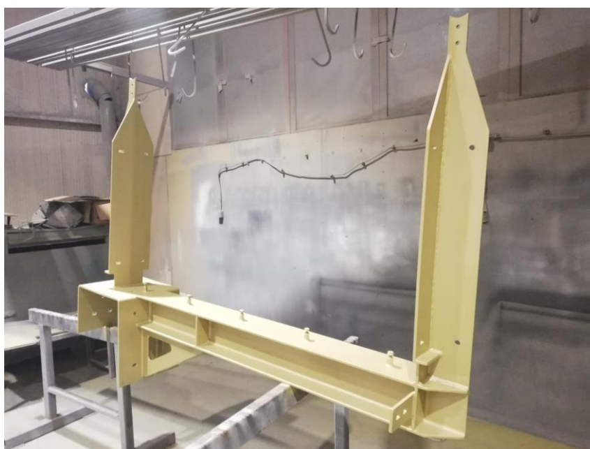
Slika 6: Čelične konzole tijekom izvedbe
